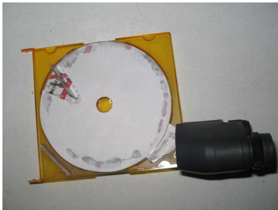
Obr. 6. Konstrukce sextantu ze dvou CD
