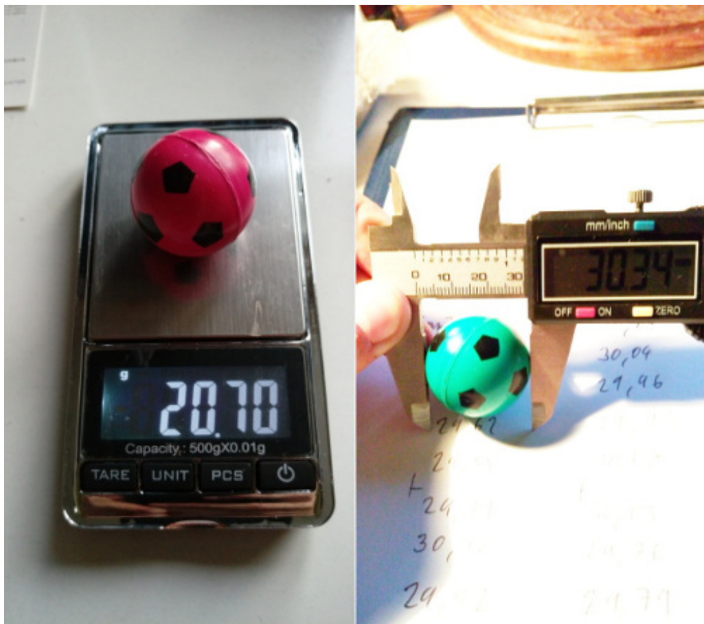
Obr. 1: Měření hmotnosti a poloměru hopíku
