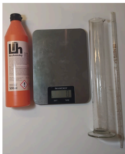
Obr. 7: Pomůcky – zleva technický líh, kuchyňská váha s přesností na 1 g, odměrný válec s objemem 200 ml a rozlišením 2 ml a pipeta pro 10 ml s rozlišením 1 ml.
