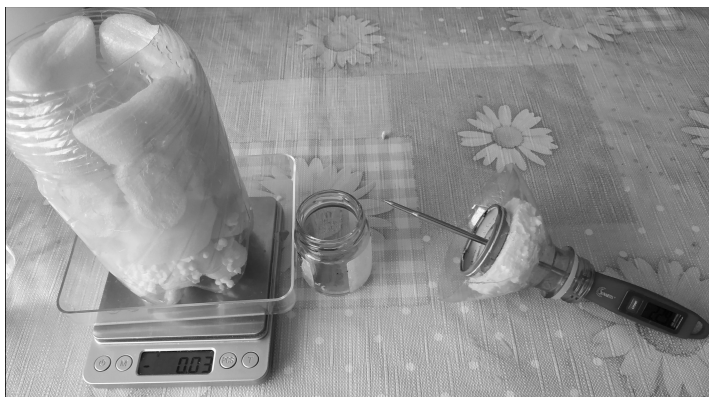
Obr. 16: Fotografie rozloženého kalorimetru. Vlevo – tepelná izolace stojící na váze, uprostřed – nádobka kalorimetru, vpravo – izolované víko s kuchyňským teploměrem.
