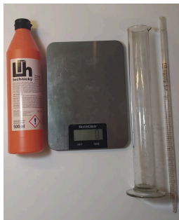
Obr. 1: Pomůcky – zleva technický líh, kuchyňská váha s přesností na 1 g, odměrný válec s objemem 200 ml a rozlišením 2 ml a pipeta pro 10 ml s rozlišením 1 ml.
