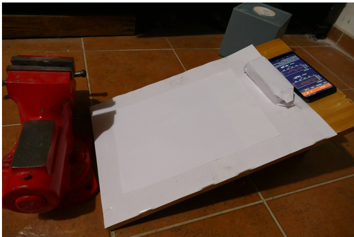
Obr. 1: Fotografie experimentální aparatury. Na nakloněné rovině list kancelářského papíru, hlava kladiva zabalená v papíru a mobilní telefon. Vzadu tuhý předmět – květináč.
